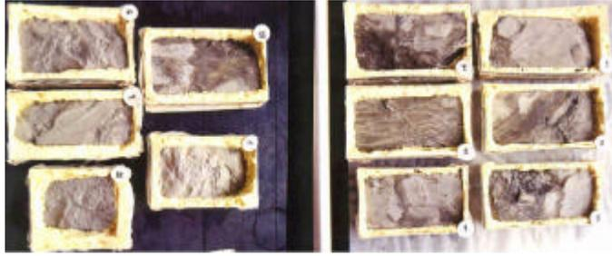
Figura 8.1: Bloques de roca inalterada en cajas al inicio del experimento
