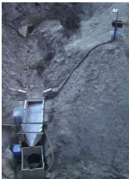
Figura 9.2: Aforador tipo H
