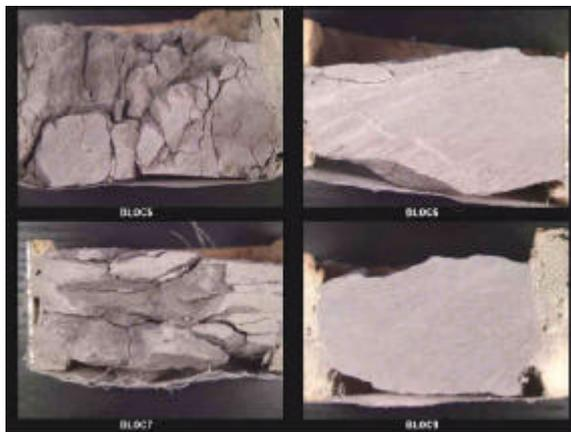
Figura 8.4: Bloques de marga controles no sometidos a ningún ciclo de humectación-dsecación (a derecha) y a la izquierda bloques sometidos a 20 ciclos de humectación desecación.
